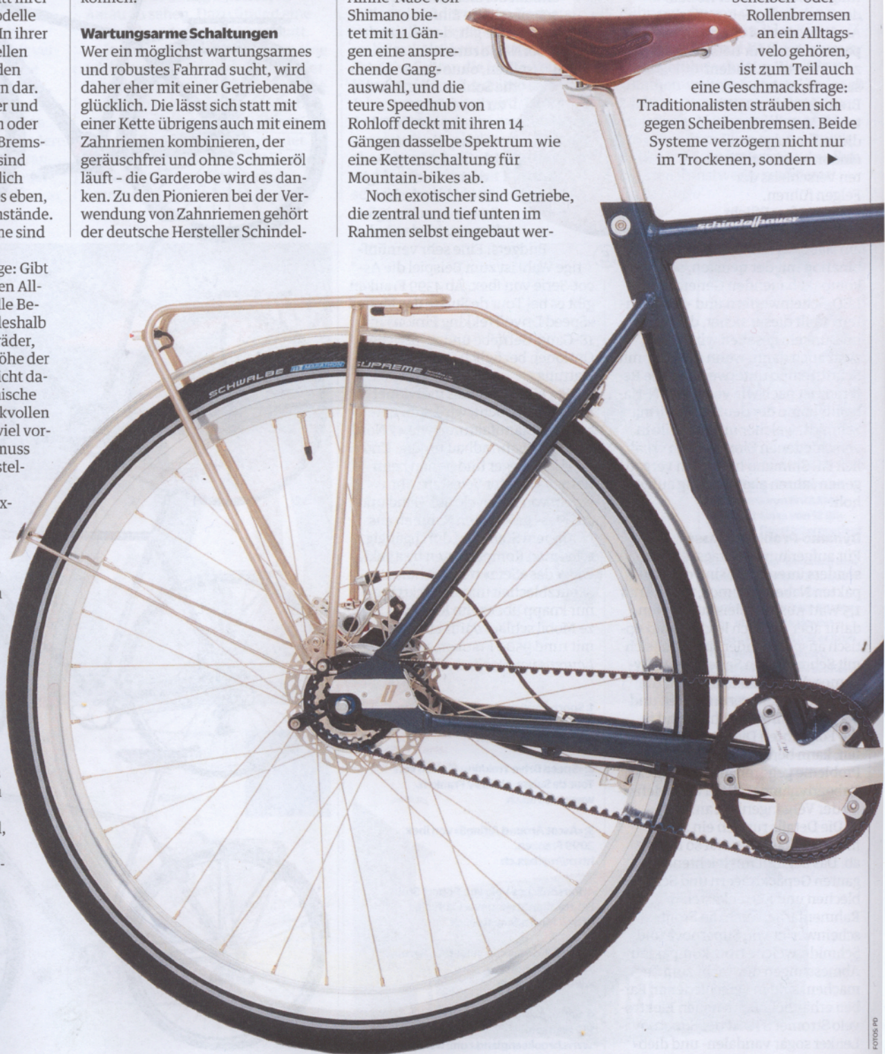
Linke Seite und rechts: Das zeitlos schöne Modell «Friedrich» von Schindelhauer hat 8 Gänge, Scheibenbremsen, eine moderne Lichtanlage und einen Zahnriemen - ab Mitte April für 2950 Franken erhältlich.
